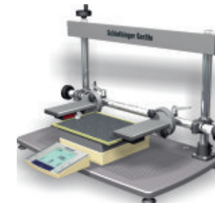
Schwindmesstechnik Schwindrinnen zum Messen von Langzeitschwinden, Schwindkegel zum Messen des frühen Schwindens und Schwindschichtsystem zum Messen von Schwinden an dünnen Schichten.
