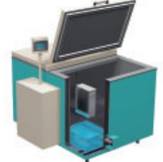
AKR-Reaktor zur Ermittlung der Beständigkeit gegen die Alkali-Kieselsäure-Reaktion
