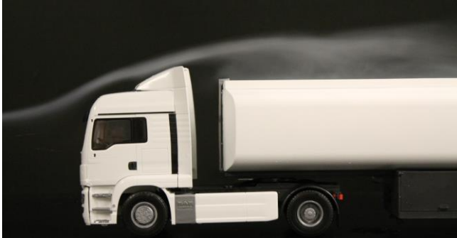
Messung C_w -Wert an einem Tanksattelanhänger
