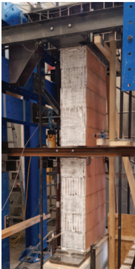
Experimenteller Versuchsaufbau des Wand-Decken-Knotens im KIB (links) und Verformungsmessung des Wand-Decken-Knotens mittels digitaler Bildkorrelation. Fotos: Jonathan Schmalz
