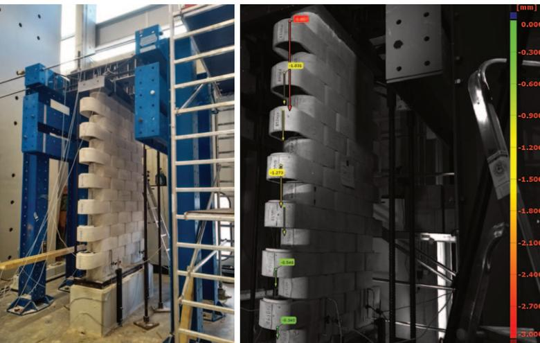
links: 2,70 m hohe Wand aus Betonhohlblocksteinen vor Beginn des Druckversuchs. rechts: Verformungsmessung der Wand mittels 3D-Messtechnik. Fotos: Jonathan Schmalz
