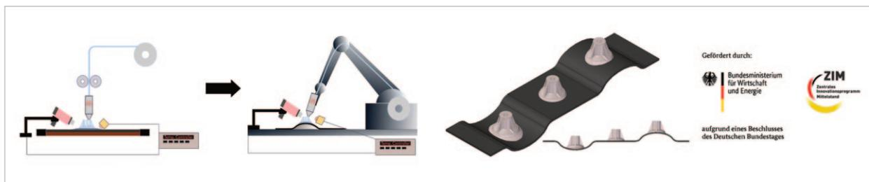
Überführung des Prozesses in ein roboterbasiertes 3D-Drucksystem (links), abstrahierte Referenzgeometrie mit ebener und gekrümmter Primärstruktur (rechts). Grafik: OTH Regensburg/Anna Afanasev
