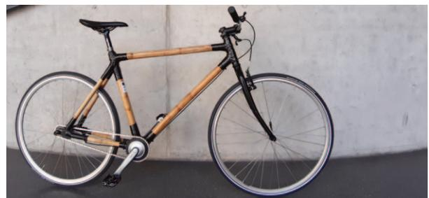
Prototyp des Bambusfahrrads, das im Labor für Faserverbundtechnik von Studierenden entwickelt wurde. Foto: Andreas Kastenmeier
