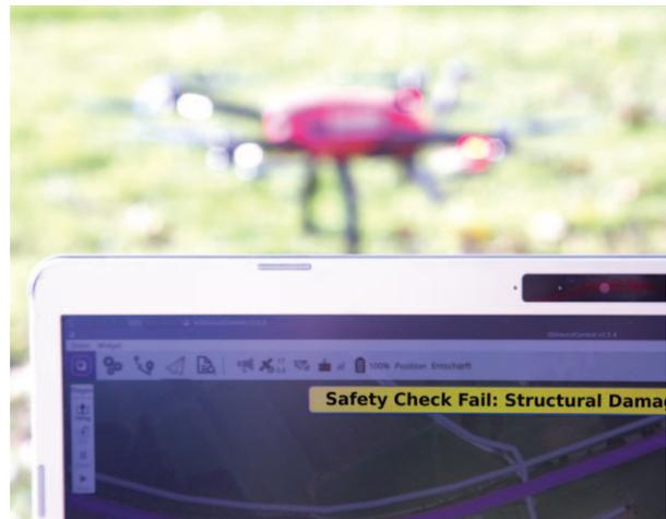
Eine neue Methode soll mechanische Schäden an der Struktur von Flugsystemen erkennen und somit Abstürze verhindern. Foto: OTH Regensburg/Florian Olbrich
