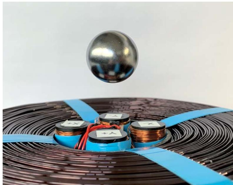
Die große äußere Spule ist radial in zwei Einzelspulen geteilt und ermöglicht das Anheben und Absenken des Kugelmagneten (30mm Durchmesser). Der Strom der vier kleineren Spulen wird so geregelt, dass die Kugel zentrisch gehalten wird. Foto: Dominik Kemeter
