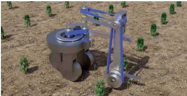
Studierende der Fakultät Maschinenbau an der OTH Regensburg haben eine 3D-Animation von einem Hackarm erstellt, der nur mit einem Motor auskommt. Foto: Tobias Eith
