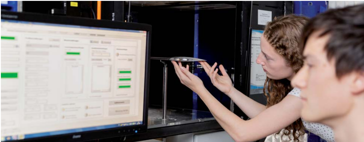
Zwei Studierende bei der aerodynamischen Vermessung eines Flügelprofils am Prüfstand POLAMAX. Foto: OTH Regensburg, Florian Hammerich
