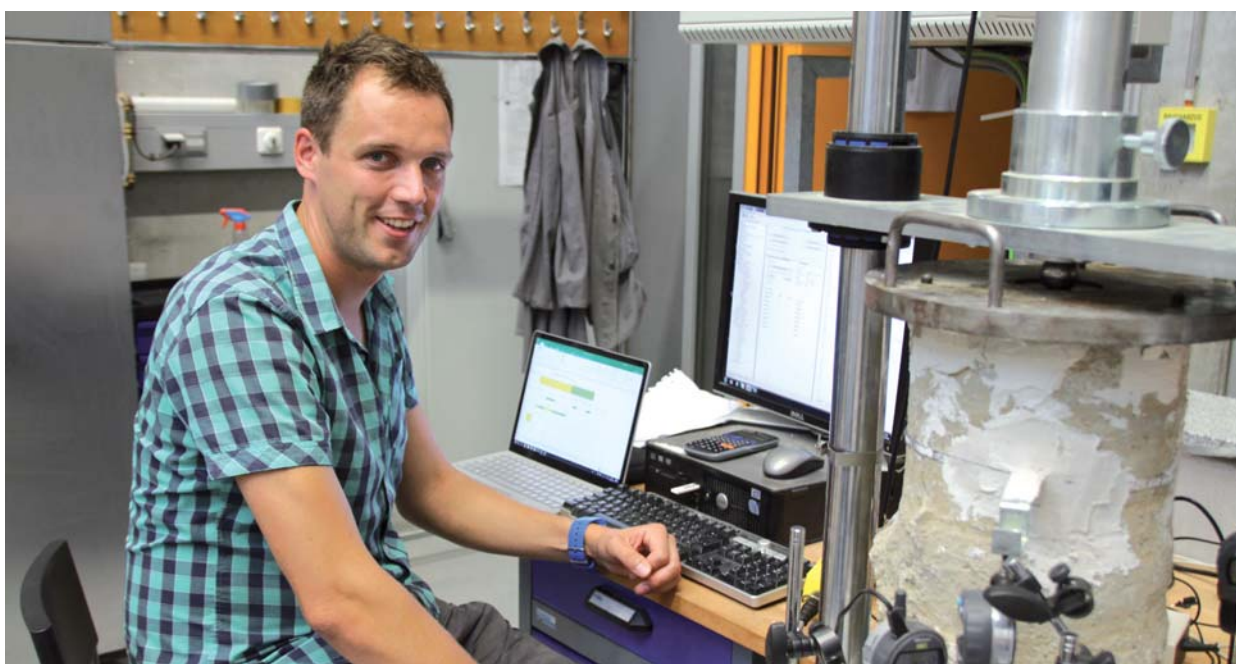
Roland Gömmel erarbeitet in seiner Promotion an der OTH Regensburg Standsicherheitsnachweise unter Berücksichtigung der Wirkungsweise von Stabilisierungssäulen. Hier testet er gerade das Elastizitätsmodul einer Säule mittels einer Prüfpresse. Foto: Diana Feuerer
