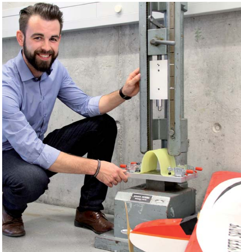
Matthias Schlamp, wissenschaftlicher Mitarbeiter im Labor Faserverbundtechnik an der OTH Regensburg, arbeitet als Projektmanager am Forschungsprojekt „BIRD“. Ziel ist es, Schäden am Flugzeug zum Beispiel aufgrund von Vogelschlägen zu lokalisieren und zu klassifizieren. Auf dem Foto ist der Versuchsaufbau zu sehen; dabei werden Fallgewichte auf ellipsenförmige Probekörper fallen gelassen und das Schadensbild mittels Sensor, Digitalmikroskop und Ultraschall ausgewertet.
