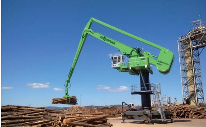
Umschlagmaschine im Einsatz: SENNEBOGEN 8130 EQ beim Holzumschlag
