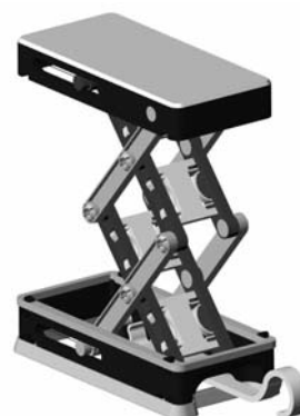
Modell eines Scherenhubtisches, konstruiert für das 3D-Drucken nach dem Prinzip des „Fused Deposition Modelling“
