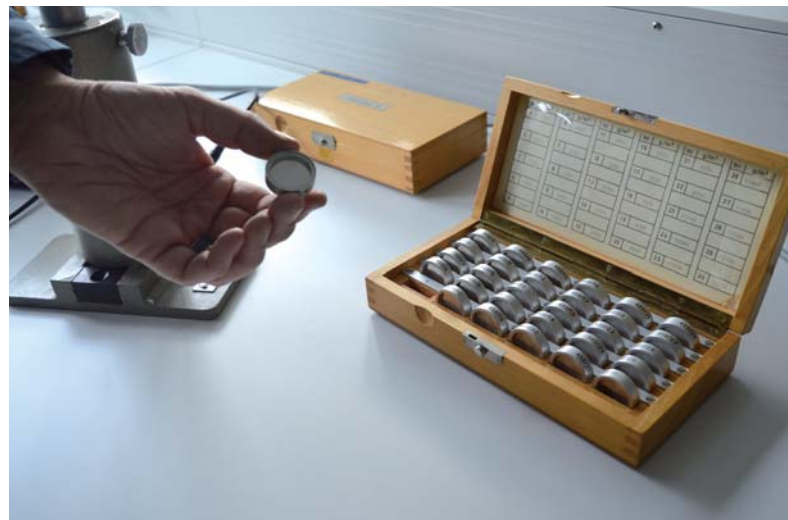
Einen Großteil der Laborausstattung hat Prof. Dr. Thomas Peterreins bereits in die neuen Räumlichkeiten umgezogen. Hier zeigt er ein Absorberblech, mit dem experimentell die Wirksamkeit verschieden starker Abschirmungen überprüft werden kann.
