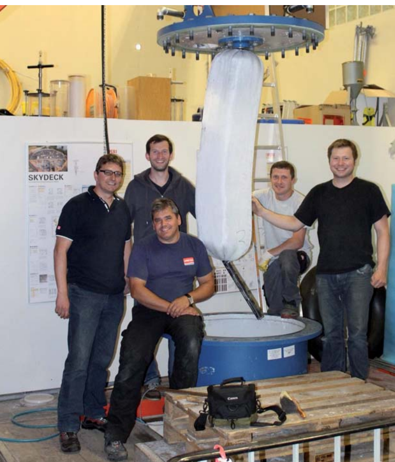
Das Versuchsteam der Uretek GmbH und der Geotechnik an der Fakultät Bauingenieurwesen der OTH Regensburg mit einem Tragelement mit 1,5 Meter Länge nach Expansion und Ausbau in der Druckzelle. In der Praxis werden Tragelemente auch über zehn Meter Länge hergestellt. Foto: OTH Regensburg
