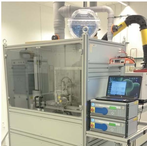
Selbstentwickelter Sprühbeschichter im Reinraum der OTH Regensburg Grafik/Fotos: OTH Regensburg
