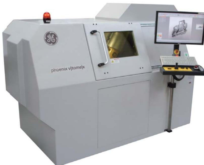
*Mit einem Micro-Computertomographen (MicroCT) können Exponate zerstörungsfrei radiologisch untersucht und in Form von Schichtaufnahmen oder dreidimensionalen Rekonstruktionen dargestellt werden.*
