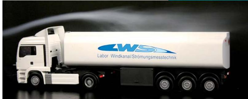
Seitenansicht des Lkw-Modells mit Sichtbarmachung der Strömung.
