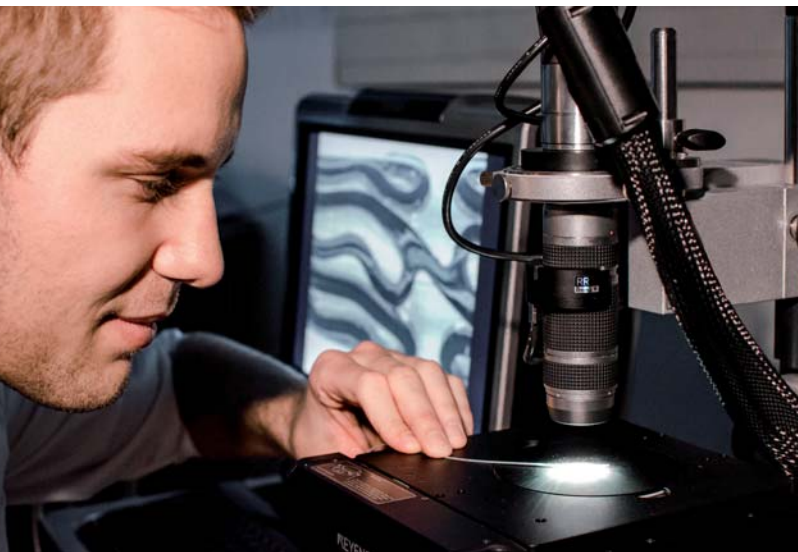
Markus Geith während der mikroskopischen Untersuchung eines Stents, hier im Labor für Medizintechnik (RCBE) der OTH Regensburg. Im Hintergrund auf dem Bildschirm sieht man die einzelnen „Struts“ des Implantats. Foto: OTH Regensburg
