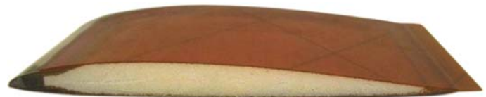
Rotorblattsegment mit Schaumkern und glasfaserverstärkten Deckhäuten. Fotos: Eurocopter
