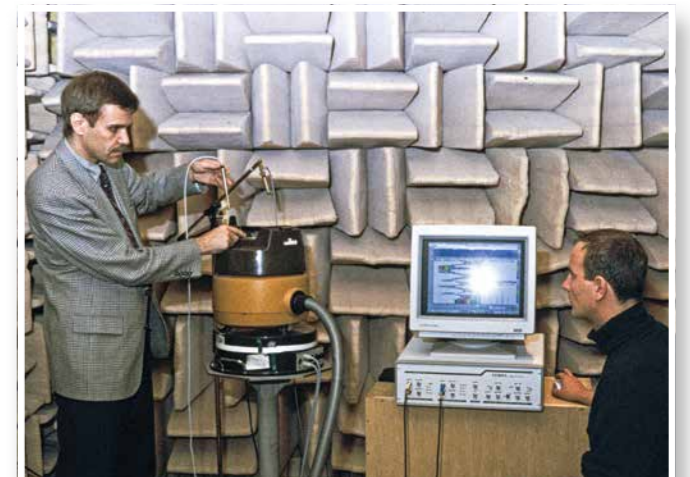
Messungen im hallarmen Raum im Labor Elektroakustik.
