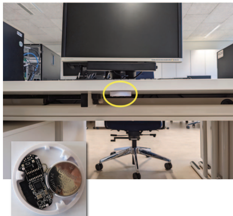
Abbildung 2: Ein BLE Beacon unter einem Schreibtisch platziert und die Innenansicht des BLE Becons
